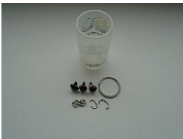
Obrázok č. 2 Valec na malé časti (Používa sa na určenie, či výrobky určené pre deti mladšie ako 3 roky predstavujú riziko udusenía, vdýchnutia alebo požitia z dôvodu malých častí)
