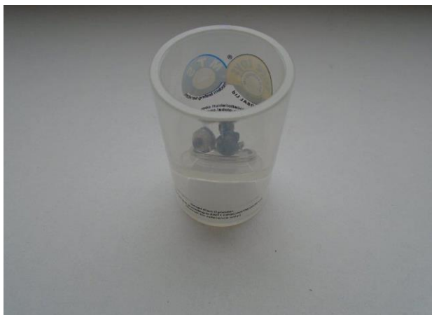
Obrázok č. 3 Z hračky oddelené malé časti úplne zapadli do valca
